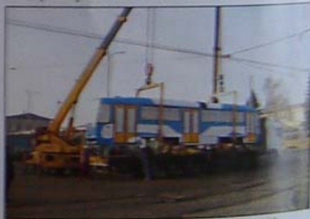
Při nakládce tramvaje v areálu ústředních dílen.
