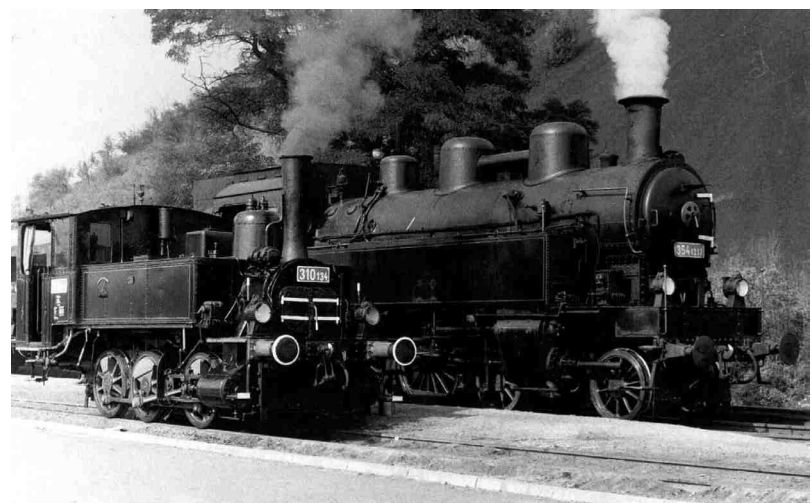
Oslavany 1980. První a poslední akce, kde se prezentovala 310 134, nemohla dopravovat vlaky, neměla zařízení tlakové brzdy (měla jen přímočinnou parní brzdou a pochopitelně ruční). Vedle je lok. 354.1, tyto stroje z LD Horní Heršpice obstarávaly desítky let osobní dopravu na jubilející trati, až do poloviny 60. let, aby pak dopravu převzaly lok. T444.1. Černý kopec v pozadí – struska a popel z kotlů elektrárny. Na vrchol haldy byl dopravován lanovkou. Foto: sbírka Hájek
