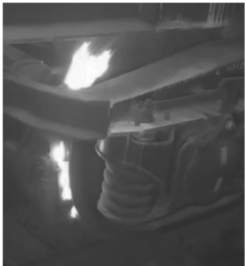
Obr. 1 Vzplanutí LL špalíků na voze Fig. 1 Burning of LL brake blocks
