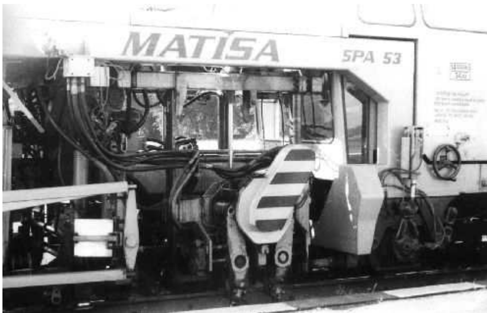
Podbíjecí mechanismus je v dolní poloze
