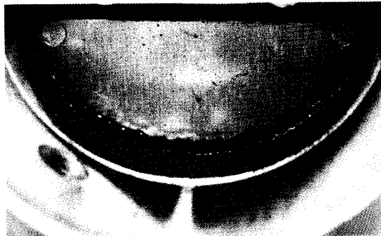
Škrťací klapka zanesená karbonem vinou nevhodného vyústění EGR ventilu v sání
